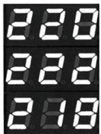
При включении прибор сразу начинает отображать значение напряжения на трех фазах.
